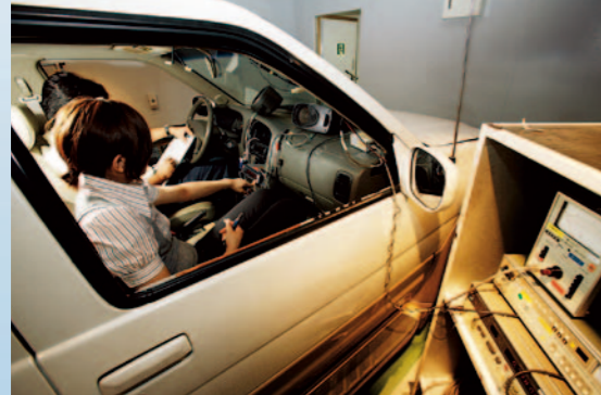
カーシールド室
